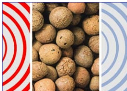
شکل ۶- دانه‌های لیکا به عنوان عایق
