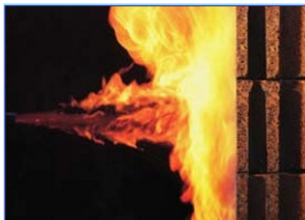
شکل ۶- مقاومت دانه‌های لیکا در برابر آتش
