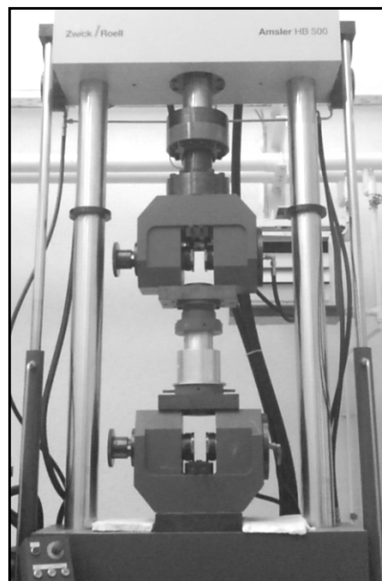
شکل ۳- سیکدانه داخل سیلندر تحت آزمایش ارزش ده درصد ریزدانه با دستگاه UTM
