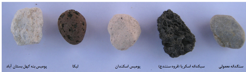
شکل ۱- ساختار ظاهری سبکدانه های طبیعی و مصنوعی و مقایسه آن با سنگدانه معمولی
