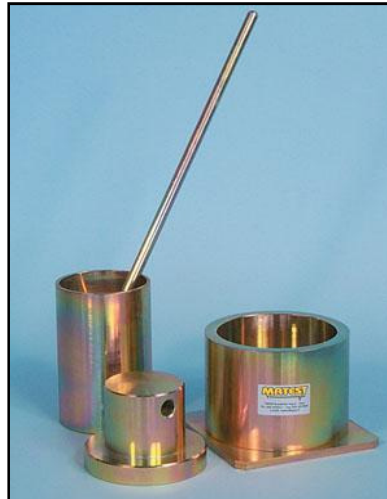
شکل ۲- دستگاه آزمایش ارزش خردشدگی و ده درصد ریزدانه
