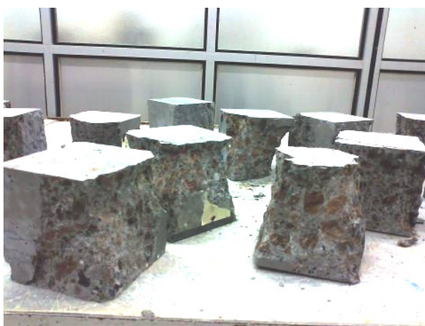
شکل ۳- نحوه‌ی گسیختگی تعدادی از نمونه‌ها در آزمایش مقاومت فشاری
